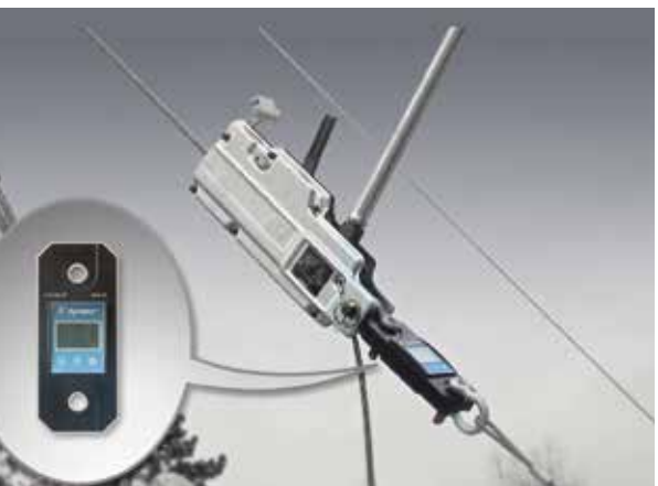
Controllo della tensione
